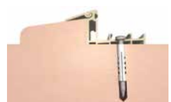
Fixation en rénovation
