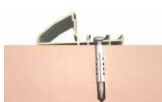
Fixation en neuf sur sol plat
