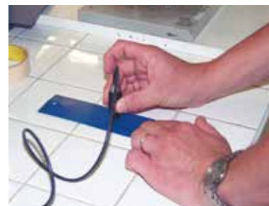
Contrôle de l'épaisseur du thermolaquage
